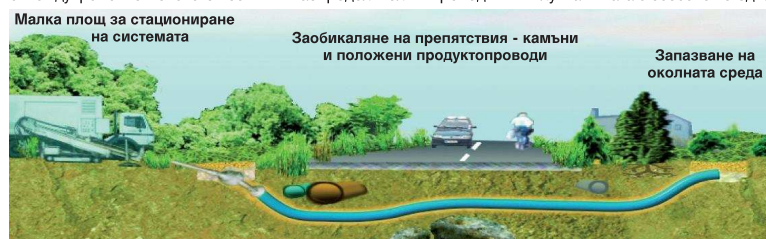
Схема на полагане с „къртица“ (HDD сондаж)
